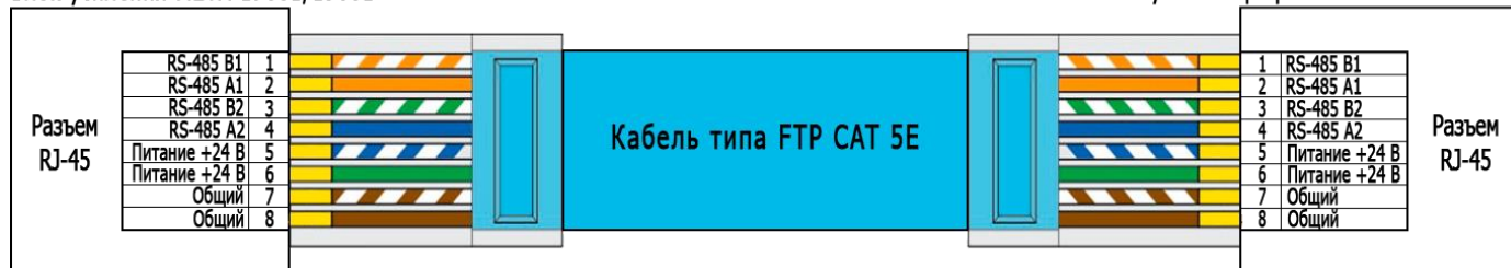
Рисунок 25. Схема подключения кабеля от БС МЕТА 17560/19560, БУ МЕТА 17661/19661 или соединительной коробки DR-2204 к МП МЕТА 18740-хх.
