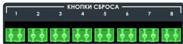
Рисунок 34. Клеммы «ВХОД КНОПКИ СБРОСА 1 – 8» для подключения УС МЕТА 7520 к БС МЕТА 19560.
