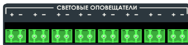
Рисунок 36. Клеммы «ВЫХОД СВЕТОВЫЕ ОПОВЕЩАТЕЛИ 1 – 8» для подключения табло МЕТА 7523 к БС МЕТА 19560.
