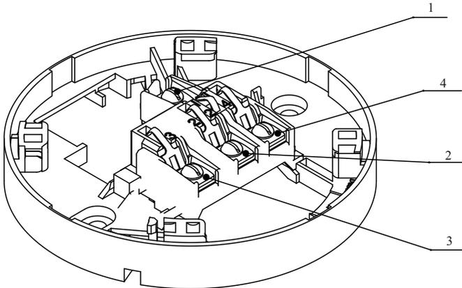
Рисунок Г.1 – Расположение клемм на базовом основании
