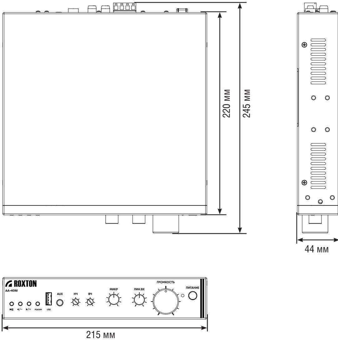
Рисунок А.1 Габаритные размеры ROXTON AA-40M
