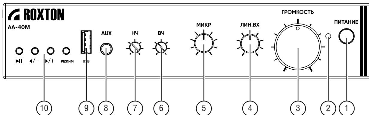
1. **Кнопка питания** — нажатие этой кнопки включает усилитель. При повторном нажатии усилитель выключается
