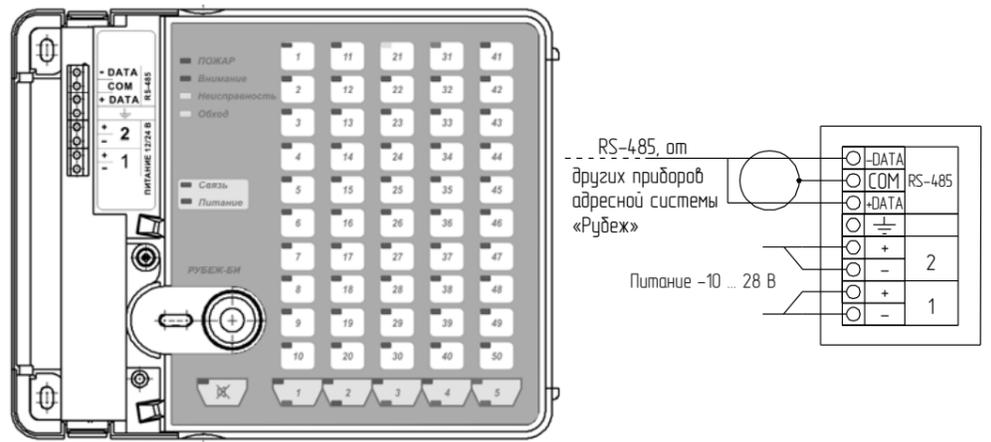
Рисунок 1 - Внешний вид и схема подключения прибора
