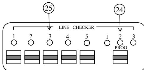
Блок контроля предназначен для дистанционного и автоматического контроля линий громкоговорителей, путем измерения импеданса линии и сравнения его с запомненным значением. При изменении импеданса от запомненного значения на 10% происходит срабатывание. Индикация неисправности осуществляется световым способом и замыканием контактов RELAY на задней панели (ПОЗ 9)
