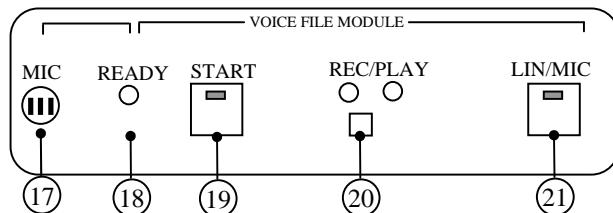
Модуль цифровых сообщений предназначен для автоматического аварийного оповещения. Блок позволяет записывать и хранить в цифровом виде одно речевое сообщение длительностью до 60 секунд.
